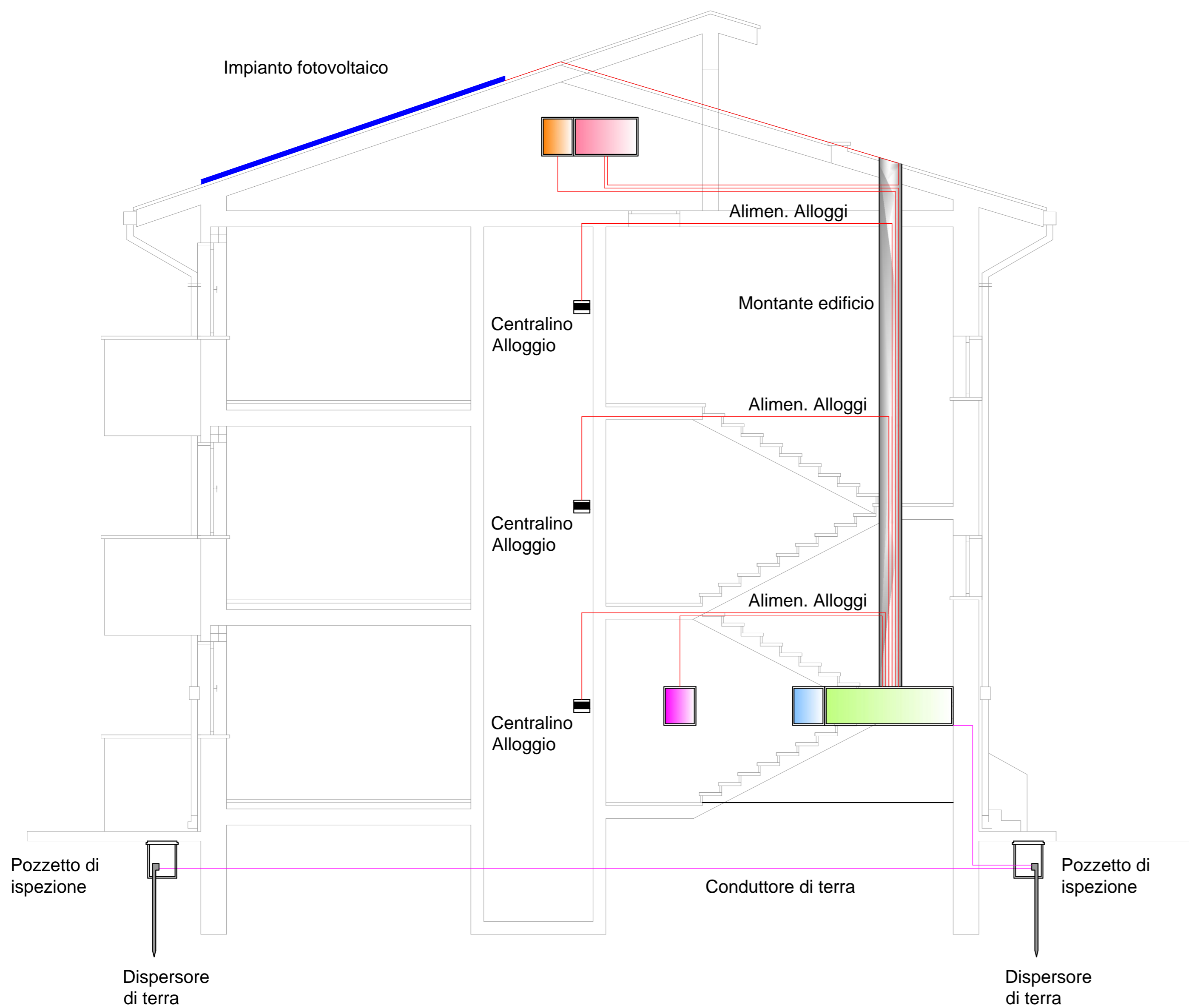
Sezione Tipo con Impianti scala 1: 50
